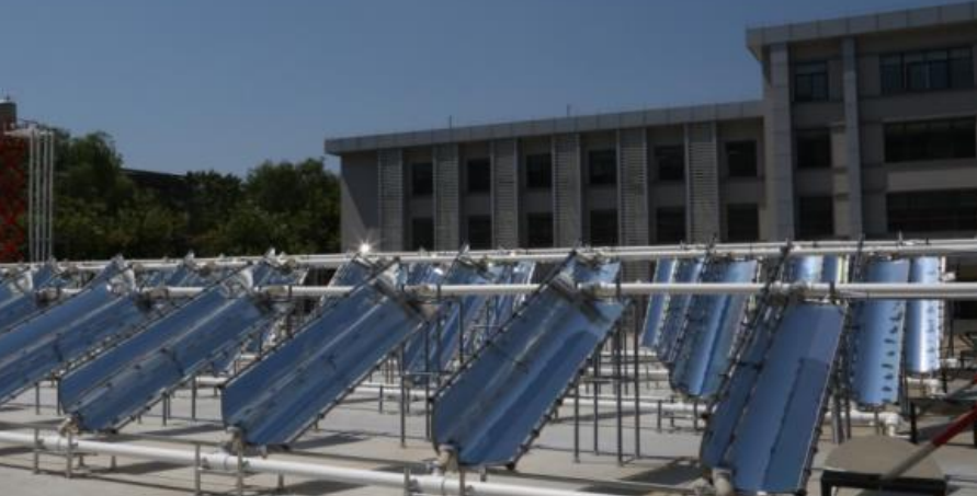
动力工程多相流国家重点实验室 直接太阳能光催化分解水规模化制氢示范系统
